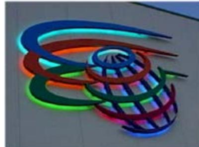
设计:每个设计师在设计招牌的时候,都需考虑该产品是否符合安全条例规定。在制作霓虹灯招牌的时候,电压要限制在 10 kV 以内,还要将高压零件和周围会导电的物体,例如:金属字或框架之间的安全距离考虑进去。
